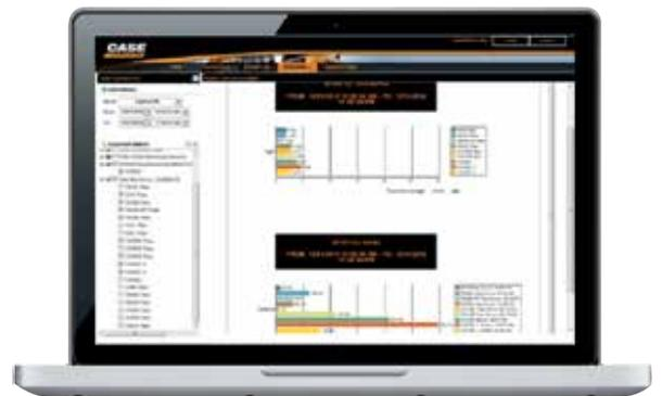
**Informe de uso de combustible:** detalles sobre consumo de combustible del equipo seleccionado. Uso común: relación de costo-beneficio del trabajo, comparación de operadores de la máquina.
