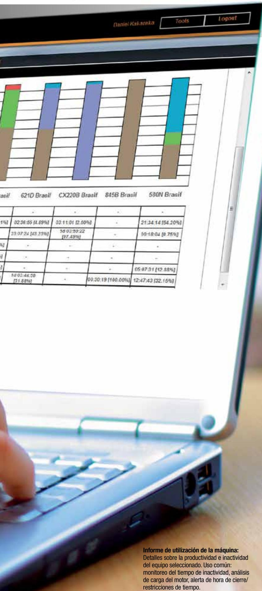
**Informe de utilización de la máquina:** Detalles sobre la productividad e inactividad del equipo seleccionado. Uso común: monitoreo del tiempo de inactividad, análisis de carga del motor, alerta de hora de cierre/restricciones de tiempo.
