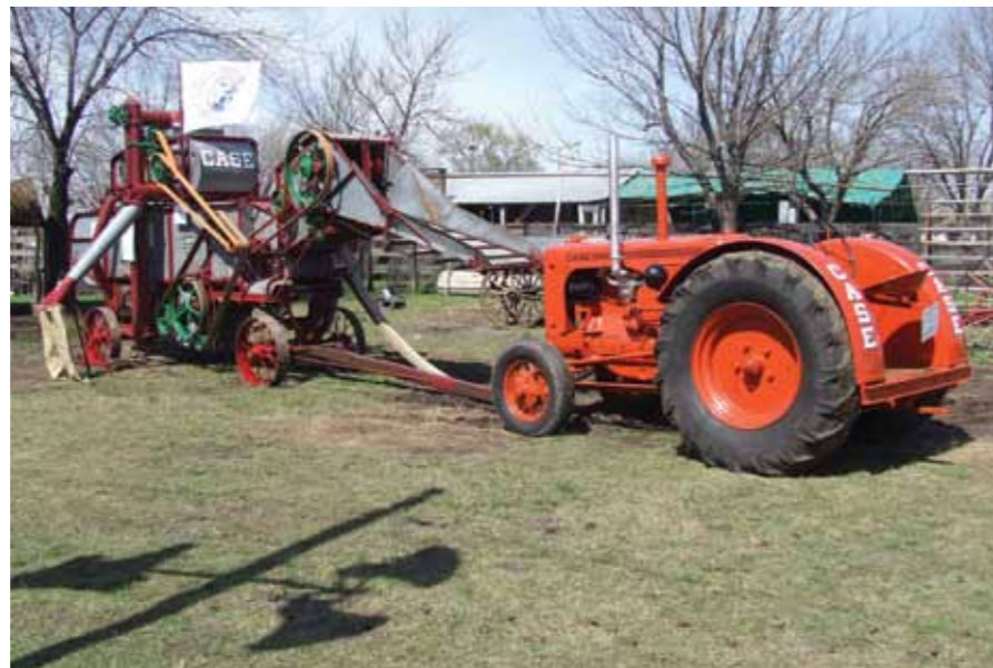
La trilladora Case en 1917 era revolucionaria por su sistema de zarandas regulables.
