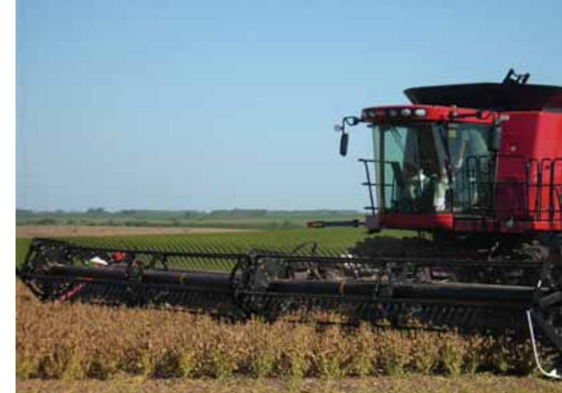
La nueva Axial-Flow 8120 tiene un nuevo acarreador para mejorar la alimentación de material al rotor.
