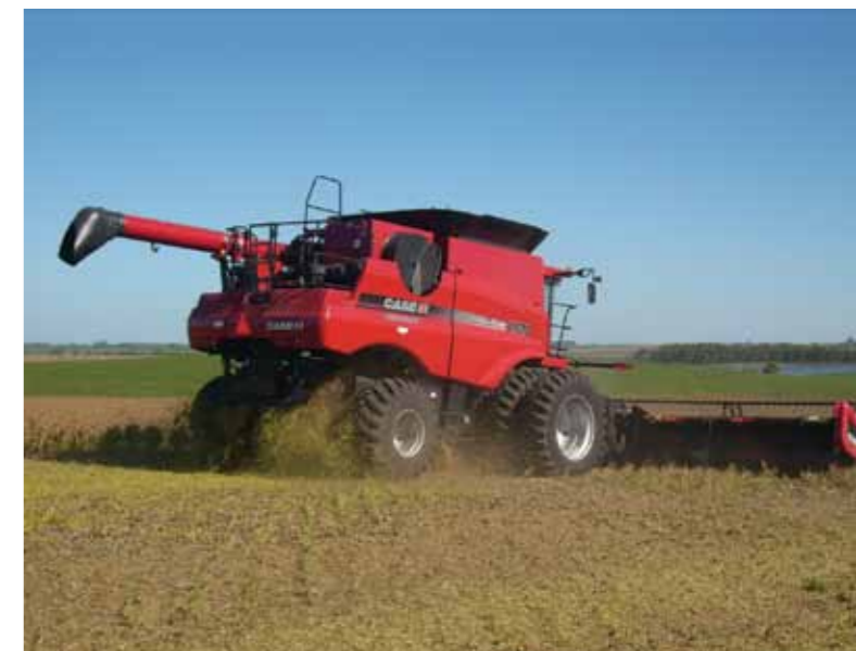
El esparcidor de granza es de accionamiento hidráulico para desparramar los residuos de manera uniforme.
