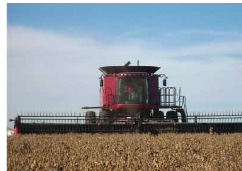
La amplia área vidriada de 5,8 m 2 de la cabina permite que el operador controle la performance de la plataforma.
