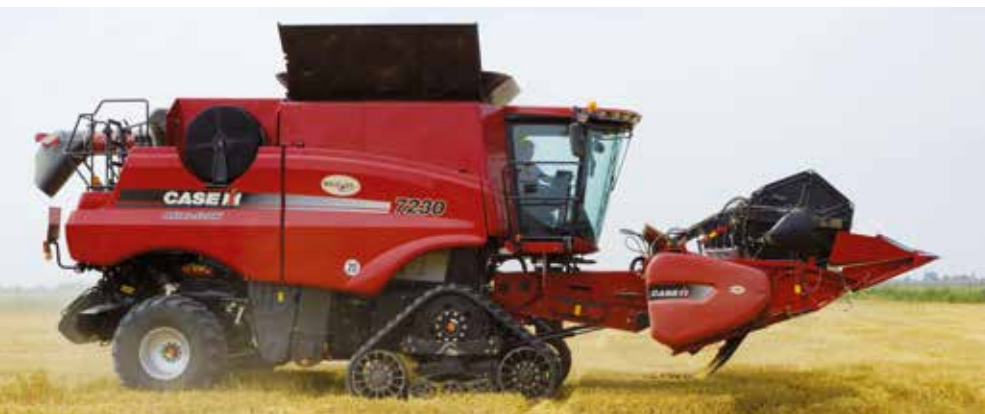
Bælte giver både lavt marktryk og har trods sin store kontakthøjde alligevel et ydre mål på kun 3,49 meter. Dermed har den meget lav transportbredde.
