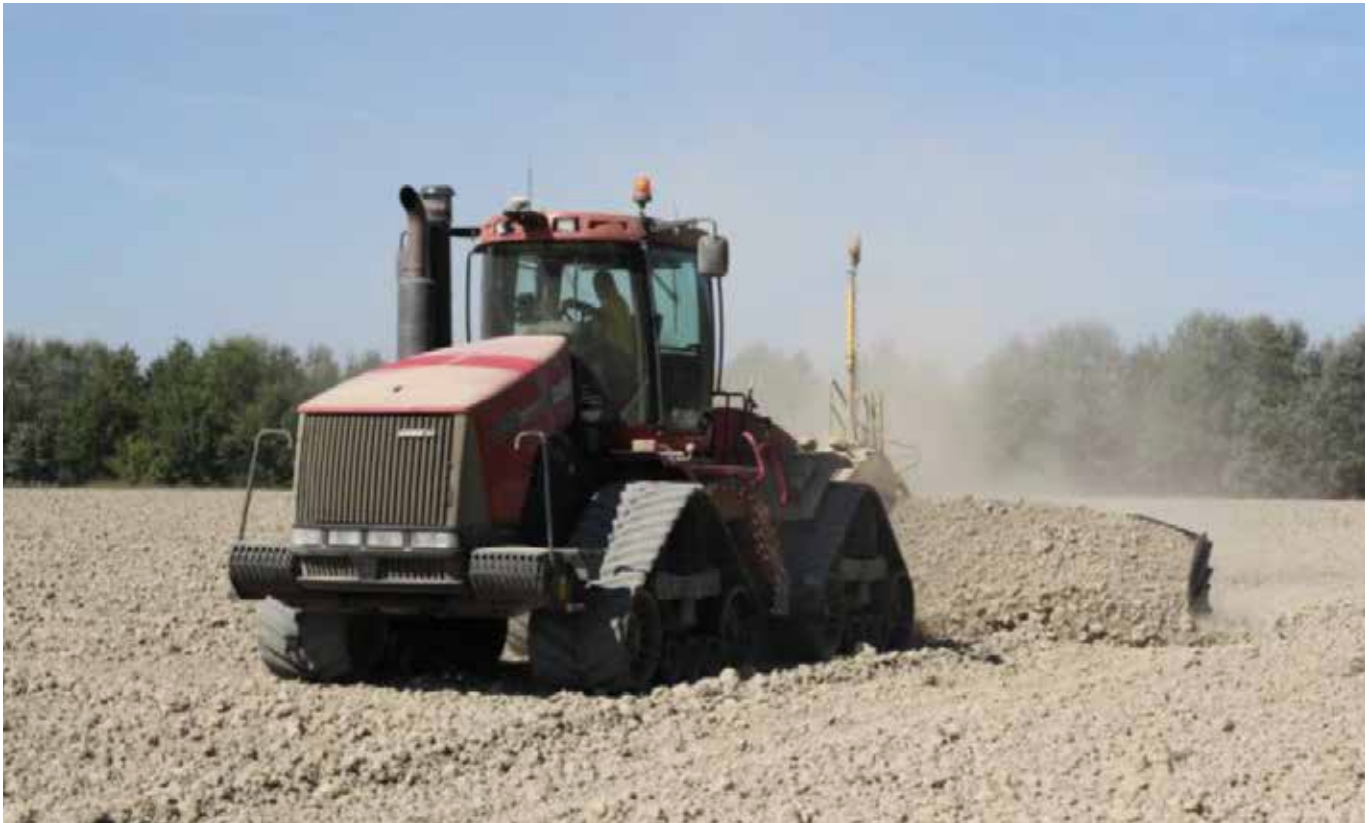
En anden fordel ved Quadtrac: Slitagen på bælteerne er betydeligt lavere end på dæk, især når jorden er hård i en varm og tør sommer.
