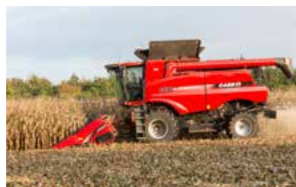
Case IH 4408 majsbordet snitter stænglerne og de fleste blade, mens kolberne føres ind gennem slugtet til rotoren, der laver en skånsom tærskning.
