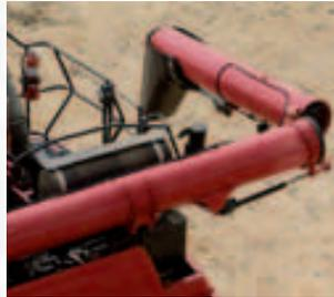
La vis de vidange de 8,80 m est disponible en version repliable pour un transport plus sécurisé sur route et pour faciliter les manœuvres. Elle s'avère être un atout pour le stockage sous les hangars.
