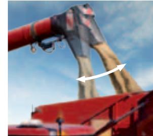
L'option d'embout sur pivot est actionnée depuis la poignée multi-fonctions et oriente le flux de grains dans la remorque, ce qui permet de la remplir totalement sans débordement.
