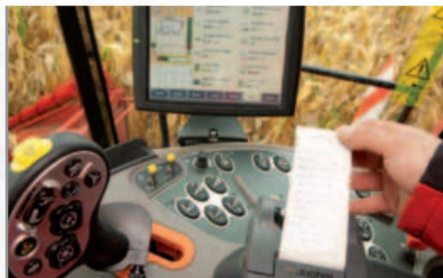
Idéal pour les entrepreneurs : une imprimante permet de livrer des données sur les performances et les zones couvertes afin de les remettre au client à la fin de chaque chantier de récolte.
