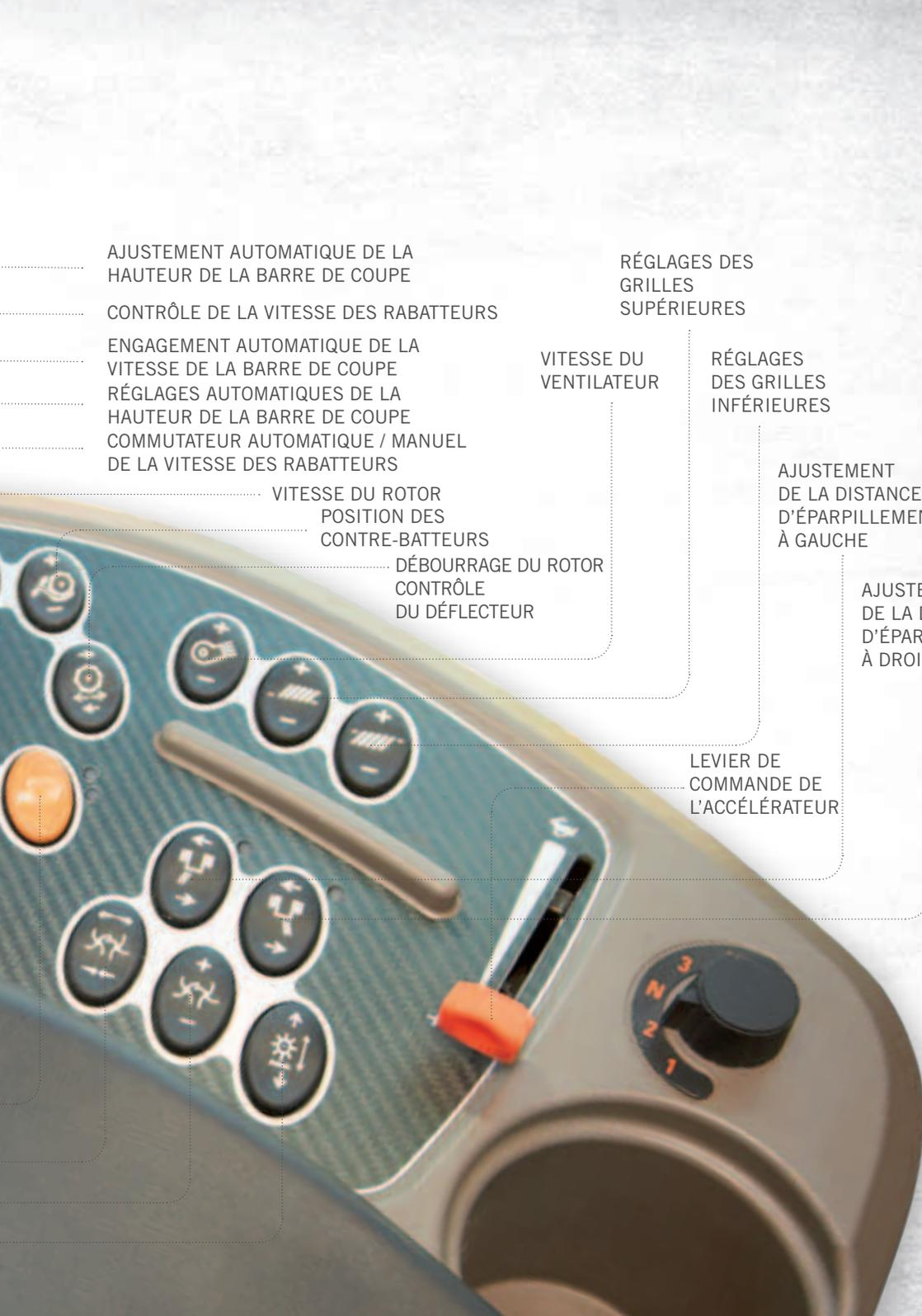
AJUSTEMENT AUTOMATIQUE DE LA HAUTEUR DE LA BARRE DE COUPE
