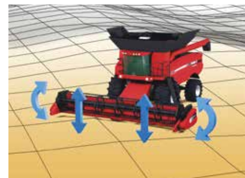
Case IH Terrain Tracker-teknologien sikrer, at en præcis klippehøjde fastholdes på selv det mest ujævne underlag.
