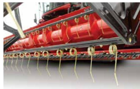
Ventaja importante: las púas alcanzan 7,5 cm por debajo de la barra de cuchillas para levantar el cultivo y reducir daños en la cuchilla.
