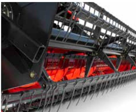
El molinete ajustable puede equiparse con púas de plástico o de acero.
