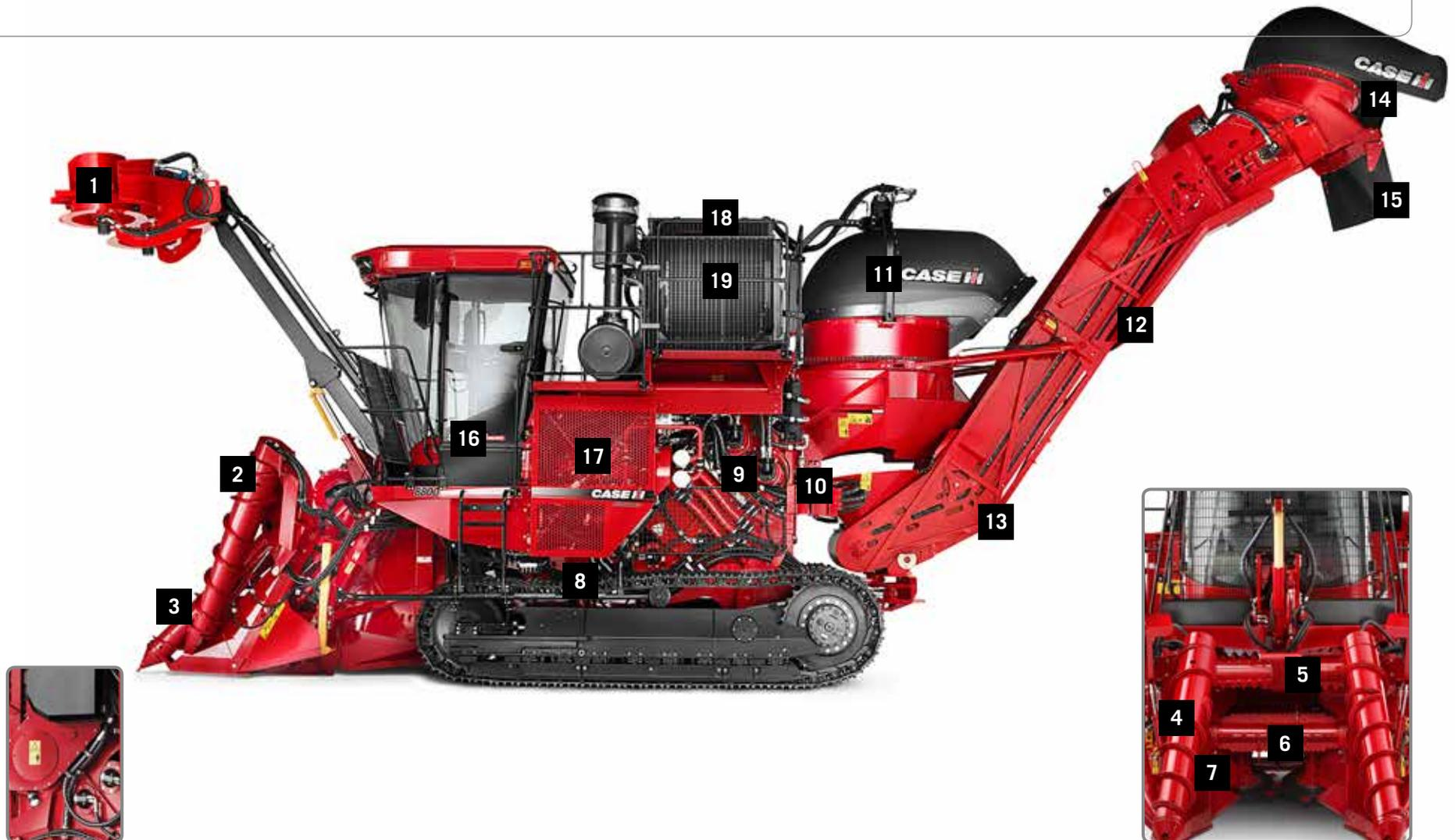
**1 Ecimeur** – Coupe les têtes et les feuilles de la canne et les répartit uniformément au sol. En plus de couper, le modèle «broyeur intégré» (option) émiette les têtes et les feuilles en morceaux de 100 mm.
