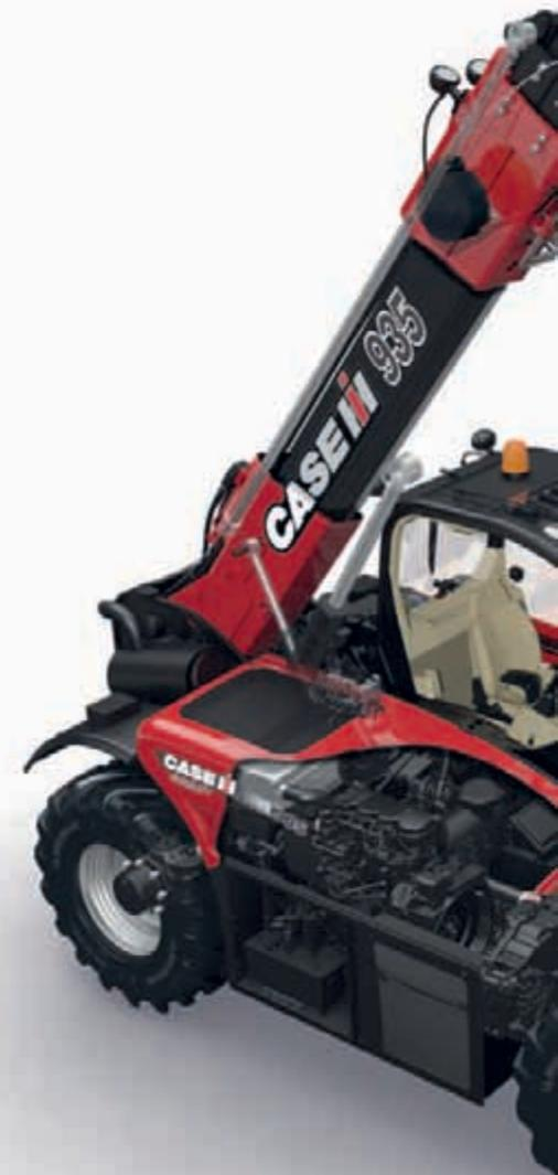
Une excellente stabilité et un fonctionnement en douceur de la flèche sont garantis grâce aux effets combinés du vérin hydraulique de compensation du Farmlift® et du vérin de basculement.
