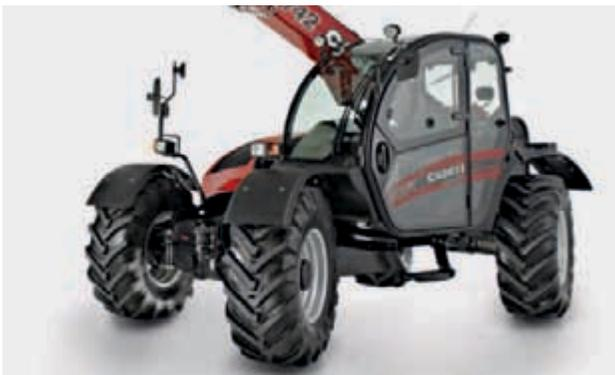
Conduite en crabe : angle de conduite en ligne droite pour travailler le long des murs par exemple.
