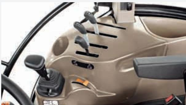
Jusqu'à 3 distributeurs auxiliaires arrière mécaniques sont disponibles pour la gamme Farmall A.
