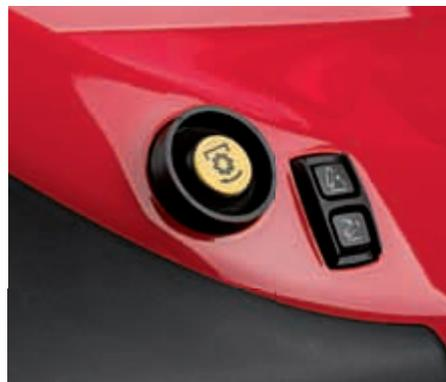
Mandos exteriores para realizar una conexión rápida y fácil del implemento.
