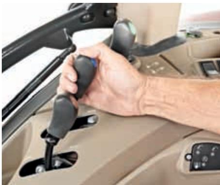
Se puede instalar hasta tres distribuidores auxiliares mecánicos traseros en la gama Farmall C.
