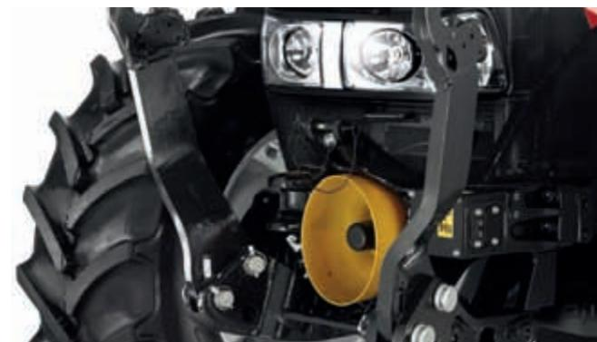
Elevador delantero perfectamente integrado con capacidad de elevación de hasta 1.670 kg (Farmall 85 C - 115 C).
