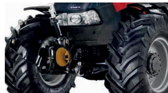
Un relevage avant parfaitement intégré avec une capacité de relevage maximale de 2 250 kg.
