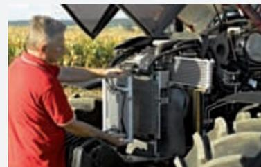
Continuez à rouler ! Les contrôles quotidiens et opérations de maintenance sont facilités avec le nouveau bloc de radiateurs pivotant et le filtre à air idéalement positionné, permettant une inspection rapide. De plus, la vérification du niveau d'huile est simplifiée, il n'est pas nécessaire d'ouvrir le capot moteur.
