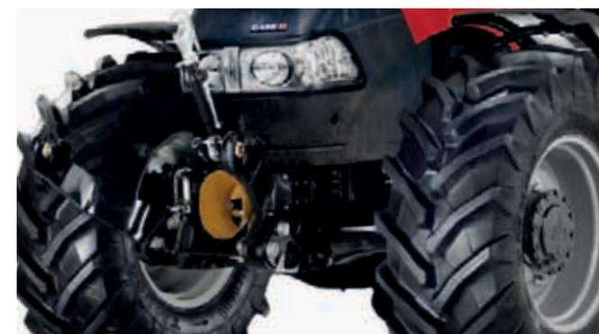
Sollevatore anteriore completamente integrato con capacità di sollevamento fino a 2.250 kg.
