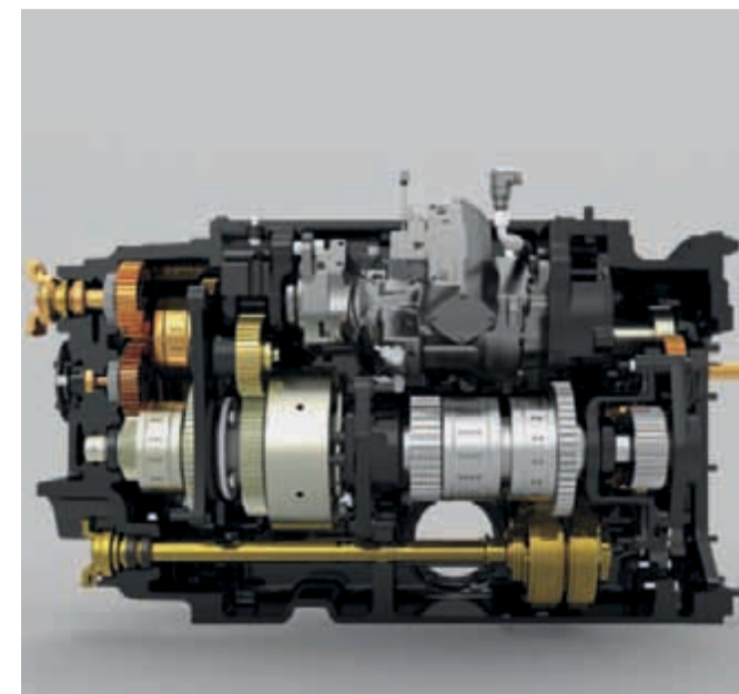
CVX-transmission – trinløst drev mellem 0-40 km/t.
