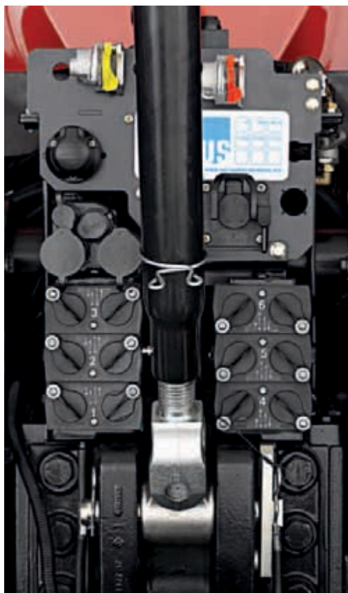
Ingen begrænsninger under arbejdet med 6 elektronisk-hydrauliske fjernventiler
