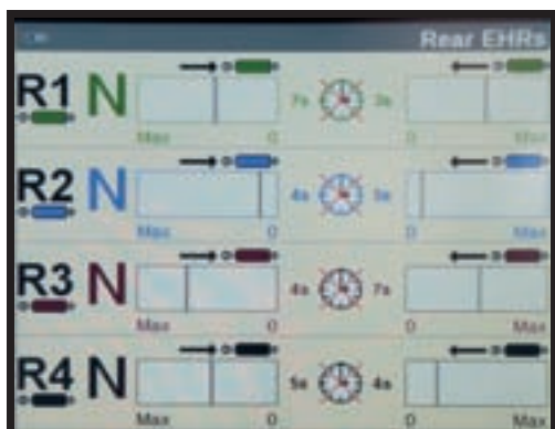
Innesto dei distributori idraulici ausiliari attraverso il monitor AFS™ Pro 700
