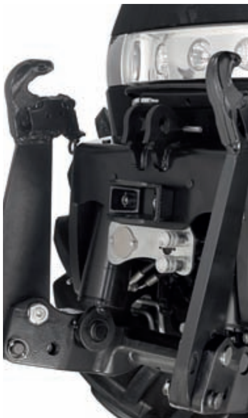
Sollevatore anteriore completamente integrato con capacità di sollevamento di 5000 kg
