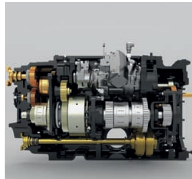
Trasmissione CVX a variazione continua da 0 a 40 km/h
