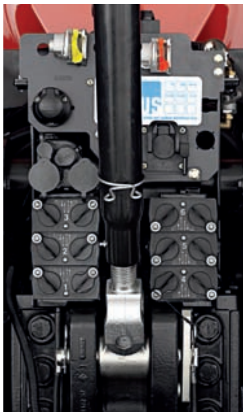
Nessun limite di operatività grazie ai 6 distributori ausiliari elettroidraulici posteriori
