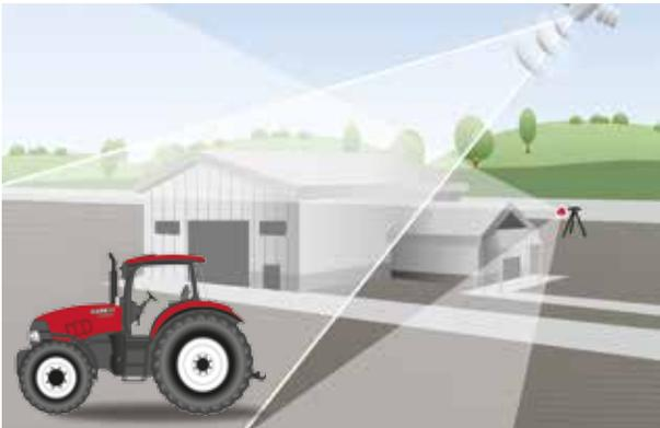
**La technologie xFill** permet de conserver la précision même en cas de perte du signal RTK jusqu'à 20 minutes.
