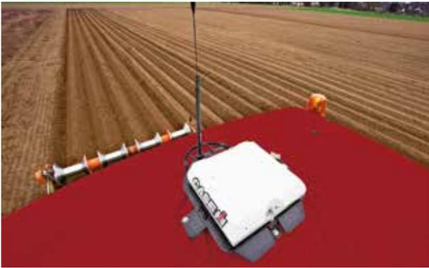
**AFS AccuGuide™** : un guidage basé sur les signaux GPS et Glonass pour une précision ultime. Des niveaux de précision centimétrique sont disponibles via les signaux RTK.
