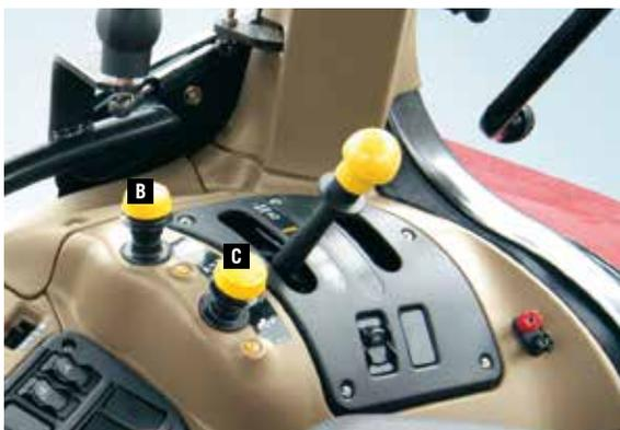
Les commandes de la prise de force des Maxxum® Multicontroller et Maxxum® CVX...
