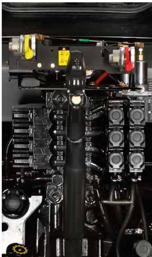
Pas de limite de fonctionnement avec 4 distributeurs arrière électrohydrauliques.
