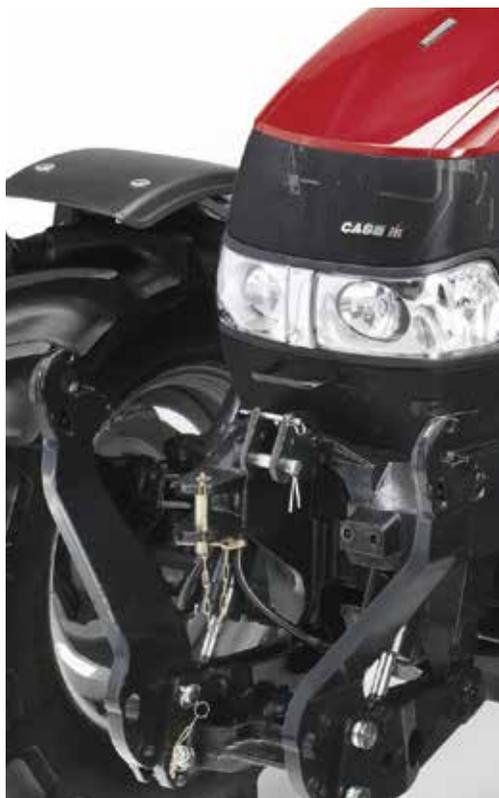
Un relevage avant parfaitement intégré avec une puissance de levage atteignant 3 800 kg. Une gestion du relevage avant optionnelle est disponible pour les Maxxum® Multicontroller et CVX.
