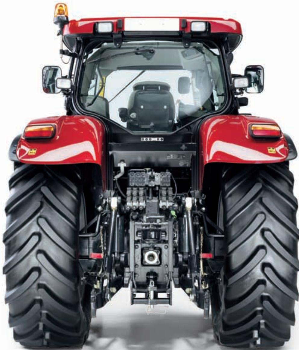
**I comandi esterni montati sul parafrang** per il sollevatore, un distributore idraulico ausiliario e la PTO rendono più semplice e agevole l'accoppiamento degli attrezzi.
