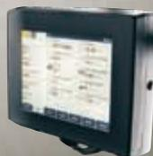
Sistema Headland Management Control™ (HMC) per la gestione automatica delle svolte a fine campo, in grado di programmare e controllare fino a 30 operazioni.
