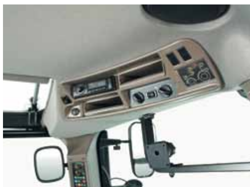
Centralt lygtepanel, klimaanlæg og radio er bekvemt integreret i taget.
