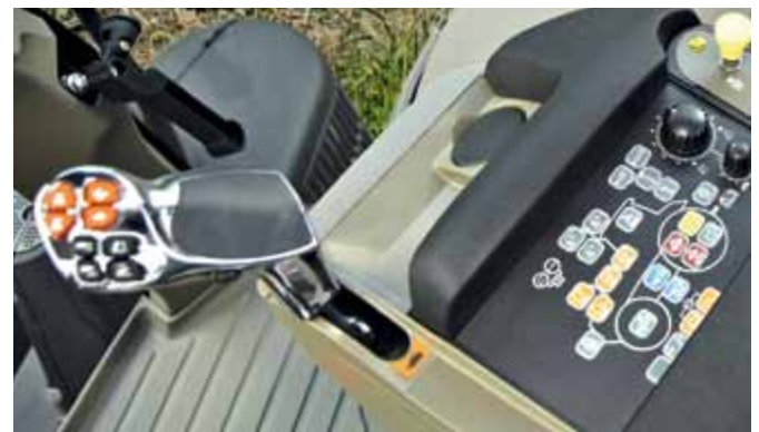
Multicontroller gør det muligt at skifte gear uden brug af koblingspedal.
