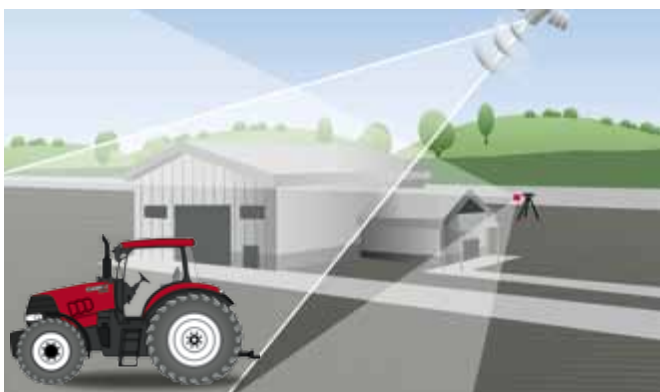
xFill holder dig på sporet i op til 20 minutter ved udfald af RTK-signalet.
