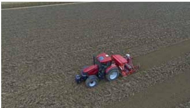
AFS AccuGuide: GPS og GLONASS baseret styring for optimal præcision uafhængig af afgrødeforholdene. RTK giver en præcision helt ned til 2,5 cm.
