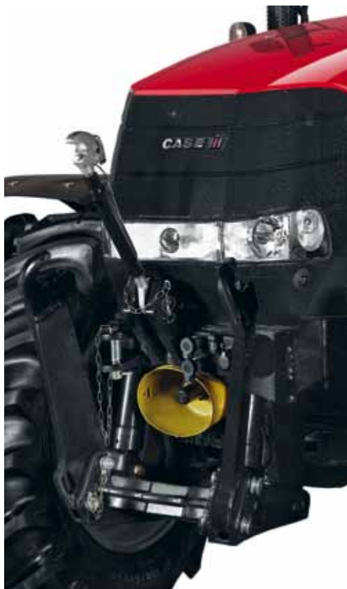
Fuldt integreret frontlift med en løftekapacitet på op til 3.800 kg.
