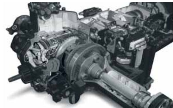
6-trins Semi-Powershift og Full Powershift transmission maksimerer effektiviteten og øger produktiviteten i marken.
