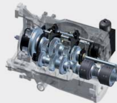
CVX-transmission – trinløst drev mellem 0-40 km/t.
