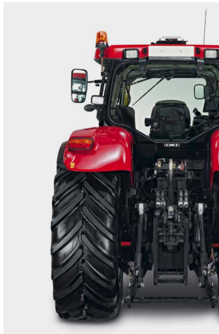
Med op til 5 elektro-hydrauliske fjernventiler klares selv de mest krævende arbejdsopgaver.
