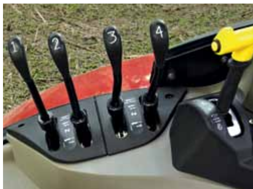
Puma og Puma CVX 130-160 modellerne fås med op til 4 mekaniske fjernventiler.
