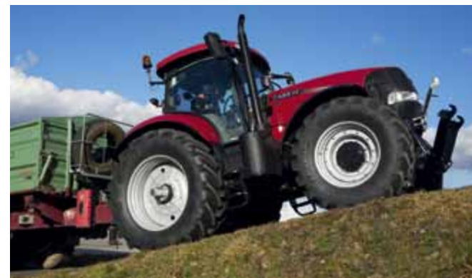
Aktiv Stop holder traktoren stille uden brug af bremses.
