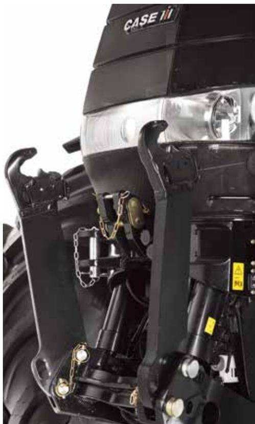
Relevage avant parfaitement intégré avec une capacité pouvant atteindre 3 785 kg.
