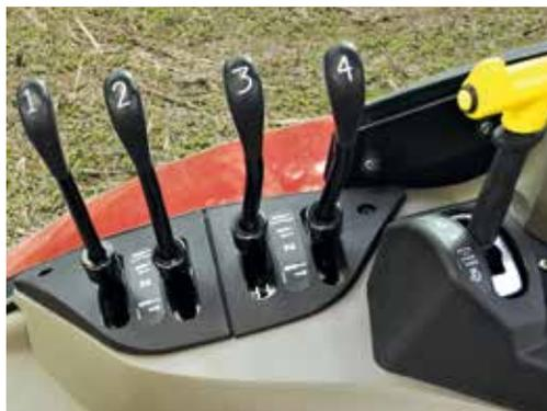
Jusqu'à quatre distributeurs auxiliaires mécaniques disponibles sur quasiment toute la gamme.
