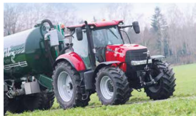
Active Hold holder traktoren stille uden brug af bremseser
