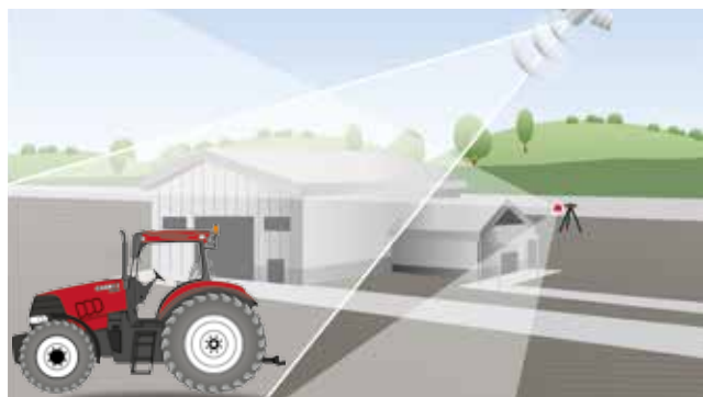
xFill funktionen kompenserer for manglende RTK signal i op til 20 minutter.
