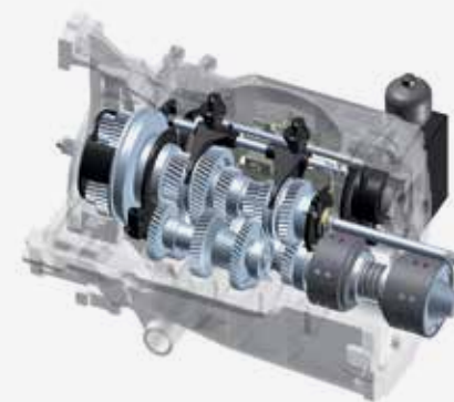
CVX transmission – trinløs kørsel fra 0-40 km/t
