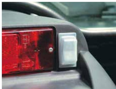
Los controles del elevador montados en el guardabarros permiten acoplar los equipos e implementos de forma fácil y segura.
