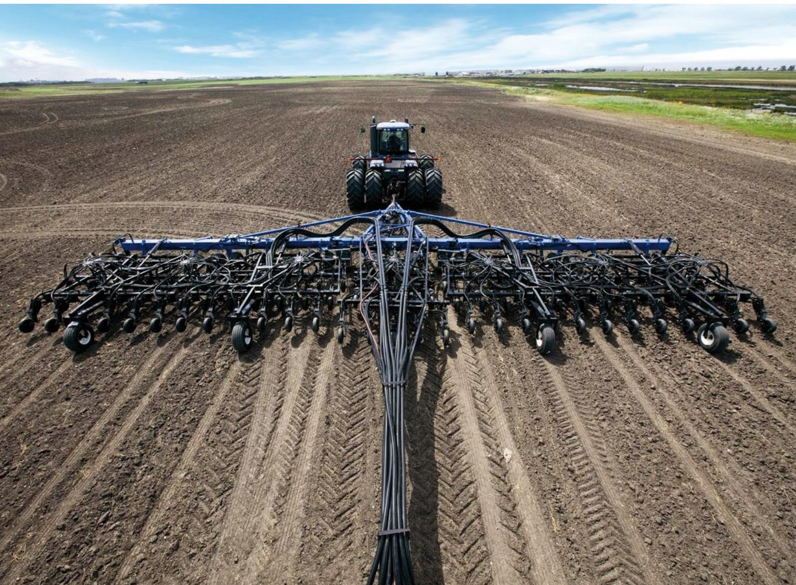
Модельный ряд пневматических сеялок New Holland P2080 и P2085 оснащен параллельно-звеньевой системой, состоящей из верхнего и нижнего рычага для обеспечения посева на равномерной глубине при всех переменных почвенных условиях. Заявленные на патент пружины с переменным
