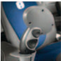
Botones de cambio y desbloqueo del avance (detrás del joystick)
