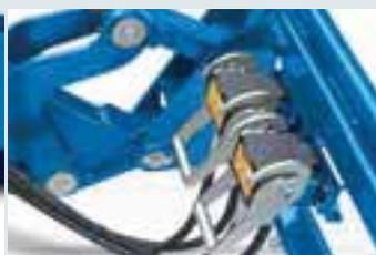
700TL 3<sup>ème</sup> et 4<sup>ème</sup> raccords hydrauliques
