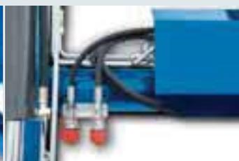
500TL 3<sup>ème</sup> raccord hydraulique
