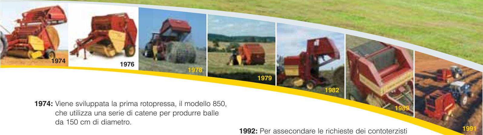
**1974:** Viene sviluppata la prima rotopressa, il modello 850, che utilizza una serie di catene per produrre balle da 150 cm di diametro.
