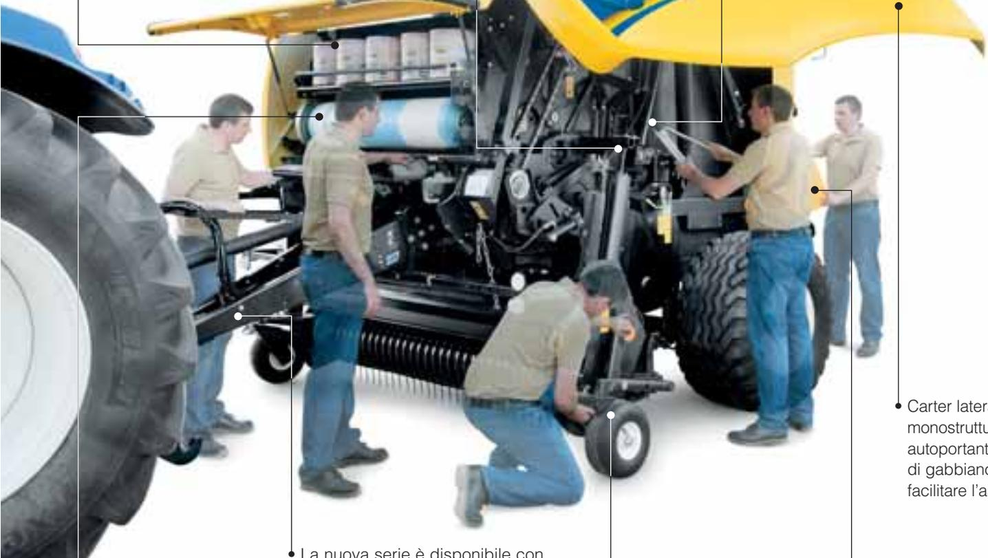
Carter laterali monostruttura autoportanti ad ali di gabbiano per facilitare l'assistibilità.
