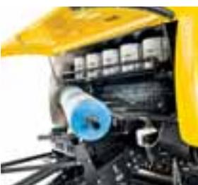
Portarotoli integrato per facilitare la sostituzione delle bobine di rete da terra.
