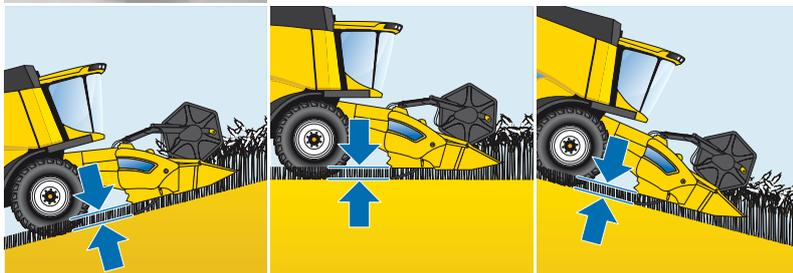
L'Autofloat™ II permette alla macchina di adattarsi ai dislivelli\*. Il sistema corregge automaticamente i "segnali di peso eccessivo" in modo da ridurre l'effetto ruspa della testata quando si lavora in discesa e mantiene un'altezza di taglio corretta quando si lavora in salita.
