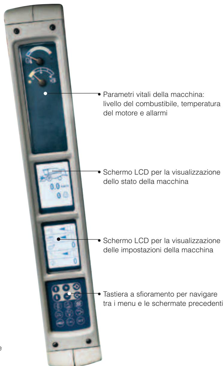
• Parametri vitali della macchina: livello del combustibile, temperatura del motore e allarmi
