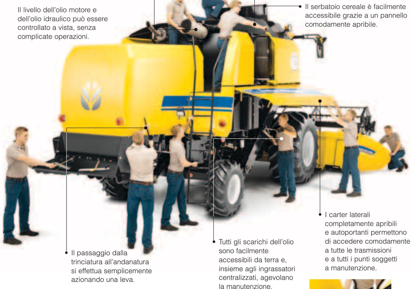
Il passaggio dalla trinciatura all'andatura si effettua semplicemente azionando una leva.
