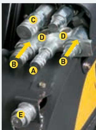
Tutti gli attrezzi idraulici sono facili e veloci da sostituire grazie alla funzione Connect Under Pressure del collettore idraulico, di serie su tutti i modelli. Premendo sull'attacco si rilascia la pressione in entrambe le tubazioni idrauliche.
