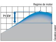
EPM de acordo com a carga da transmissão, tomada de força e sistema hidráulico.
