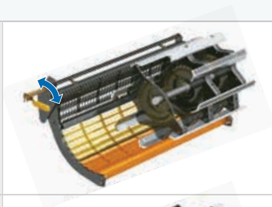
Standard tröskcylinder och slagskosektion för små kärnor
