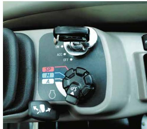
Операторы могут сохранять до **десяти дополнительных настроек расхода гидравлического масла** (и давления гидравлического масла по заказу), что позволяет им легко и быстро менять навесное оборудование без необходимости каких-либо механических регулировок.
