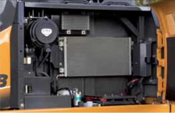
Les pelles Case CXB obtiennent le score le plus bas dans le système de notation de la maintenance SAE et réduisent les temps d'arrêt et les coûts de maintenance. Tous les filtres sont regroupés et offrent un accès depuis le sol qui simplifie la maintenance et réduit la durée d'entretien.
