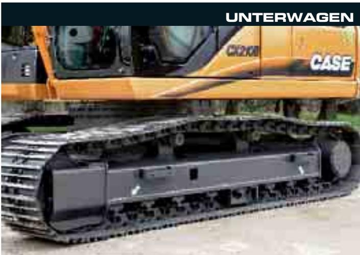
Die besondere Konstruktion der Unterwagen garantiert bei CASE Raupenbaggern eine lange Lebensdauer der Komponenten und niedrige Betriebskosten.
