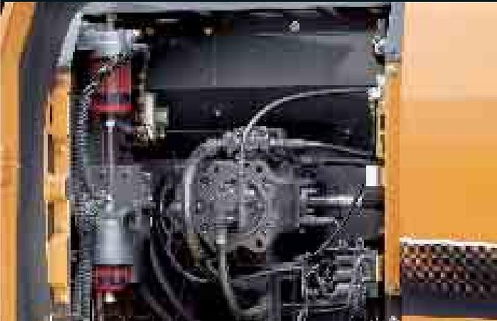
La CX210B ofrece más avances en el diseño hidráulico, y emplea eficientes bombas de pistón para maximizar la presión y el caudal. La máquina usa un sistema de par de bomba de control variable que adapta la potencia del motor a la demanda hidráulica, y responde con rapidez al movimiento del operario para garantizar una elevada productividad.
