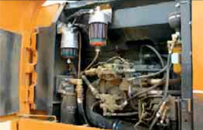
La CX230B utilise un système de commande variable du couple des pompes hydrauliques pour maintenir un régime moteur optimal même en cas de lourde charge de travail. Les commandes réagissent rapidement aux demandes de l'opérateur, ce qui permet d'économiser 5 % de carburant en plus. Des pompes à piston améliorées et aux tolérances supérieures réduisent les pertes hydrauliques et contribuent à une réduction supplémentaire de 2 % du carburant.
