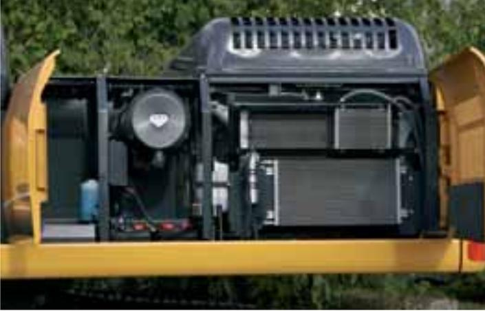
Zentral gruppierte Filter sind leicht im Stehen erreichbar und erlauben geringere Servicezeiten. Case Hydraulikbagger erreichen niedrigste Werte im SAE-Serviceindex und reduzieren so Stillstandszeiten auf das Minimum.
