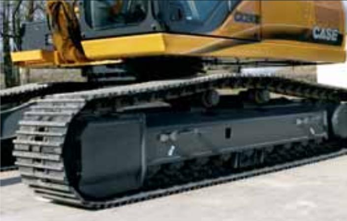
Die besondere Konstruktion der Unterwagen garantiert bei CASE Raupenbaggern eine lange Lebensdauer der Komponenten und niedrige Betriebskosten.
