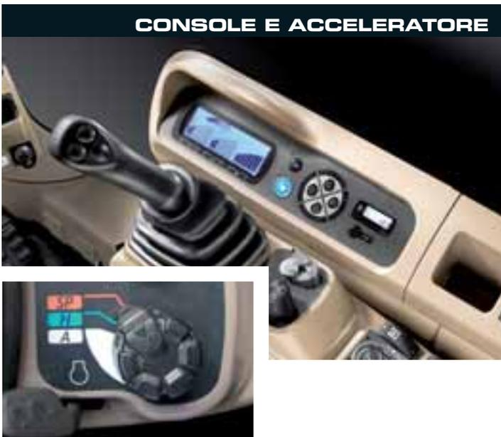
Il comando avanzato dell'acceleratore del motore, che determina anche la selezione della modalità di lavoro, è integrato nella console di destra completamente regolabile. La console prevede inoltre un sensore di luminosità, che assicura una lettura chiara e agevole della grafica anche in pieno sole. La disposizione centralizzata degli interruttori facilita il funzionamento della macchina, mentre i manipolatori corti ne migliorano la controllabilità.
