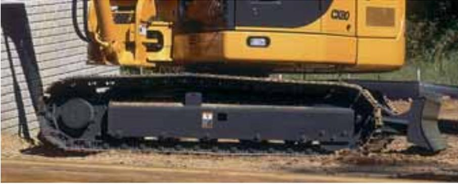
Telaio tipo LC, che con la sua lunghezza assicura un'eccellente stabilità e una capacità di movimentazione di carichi paragonabile a quella degli escavatori standard.
