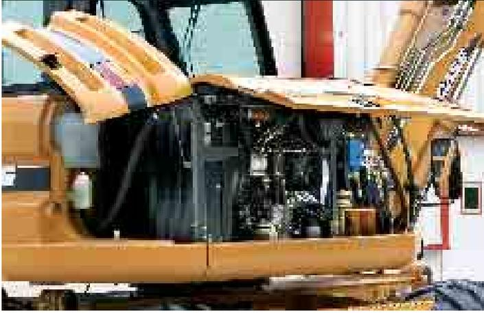
Il motore diesel turbocompresso a controllo elettronico soddisfa la normativa antinquinamento Tier III. Nei test effettuati il motore da 112 CV (84 kW) ha dimostrato di offrire maggiore produttività con una riduzione del consumo di carburante fino al 12%. Il sistema di comando e controllo del motore e della pompa idraulica assicura un utilizzo versatile ed altamente efficiente, incrementando così la produttività e il rendimento tonnellata/litro a tutto vantaggio del cliente.
