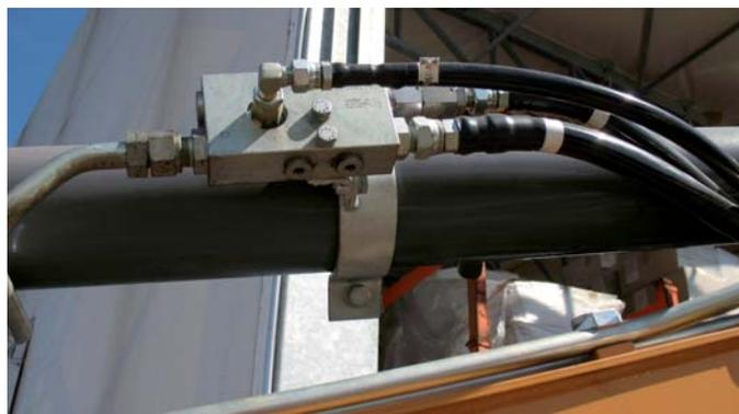
Clapets de sécurité comprises dans le kit de manutention sécurisée
