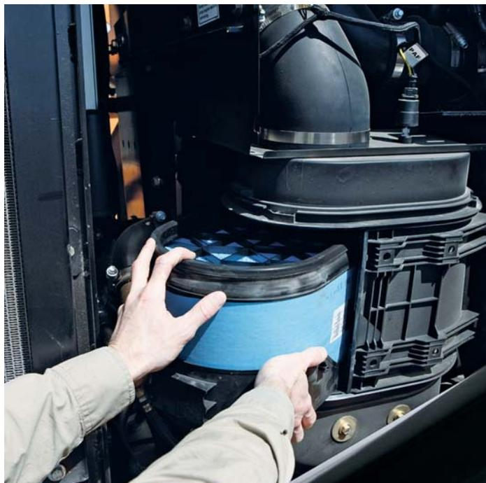
Le filtre à air est facile à retirer, et la poussière est aspirée et rejetée dans le pot d'échappement.
