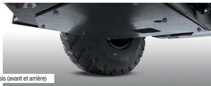
Protection sous châssis (avant et arrière)
