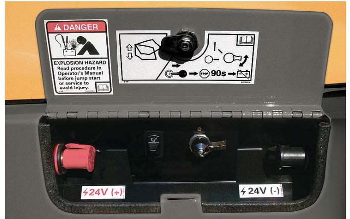
Commutateur d'ouverture du capot et coupe-batterie. En cas de batterie déchargée, l'installation de câbles de démarrage est facilitée et sécurisée.
