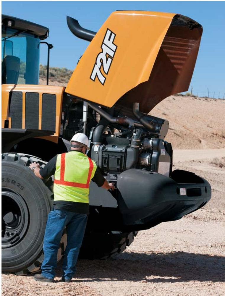
La disposition des composants sous le capot est optimisée et facilite l'entretien.
