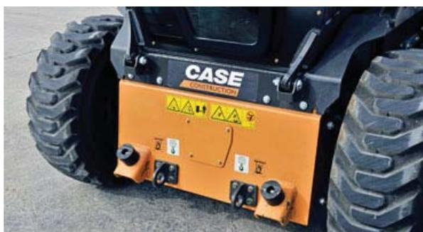
Direkte Abstützpunkte am Fahrwerksrahmen unterstützen die Schubleistung
