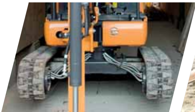
Ausgefahrener Unterwagen für höhere Stabilität im Einsatz
