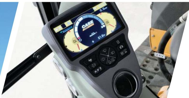
*Pantalla LCD de 7" a todo color: diseño moderno e información completa.*
