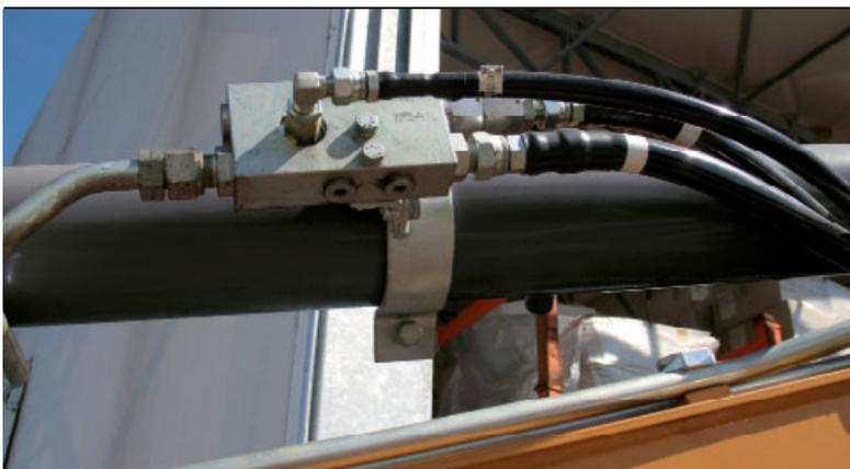
Válvulas de seguridad incluidas en el equipo de manipulación segura
