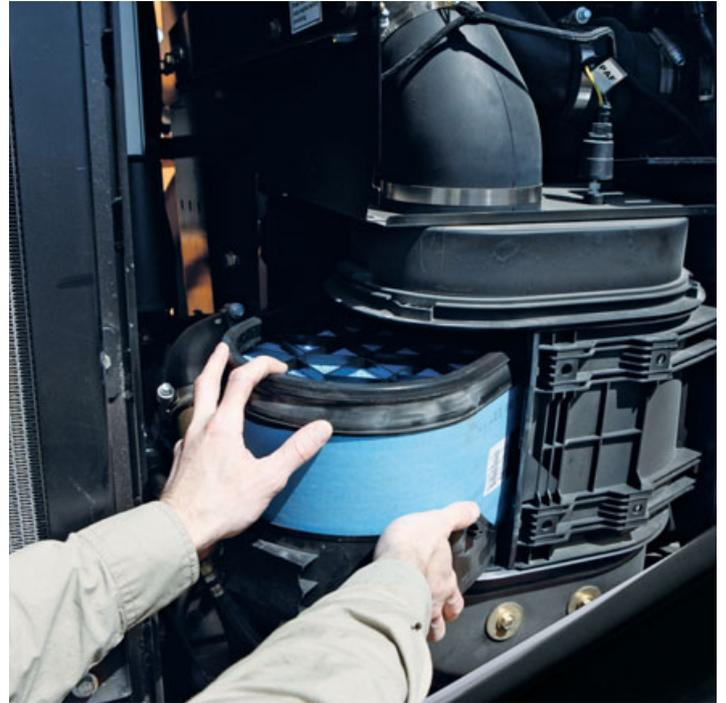
Se puede retirar fácilmente el filtro de aire, y el polvo se aspira y se expulsa con los gases de escape.
