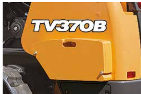
Contrepoids additionnel pour augmenter le ROC
