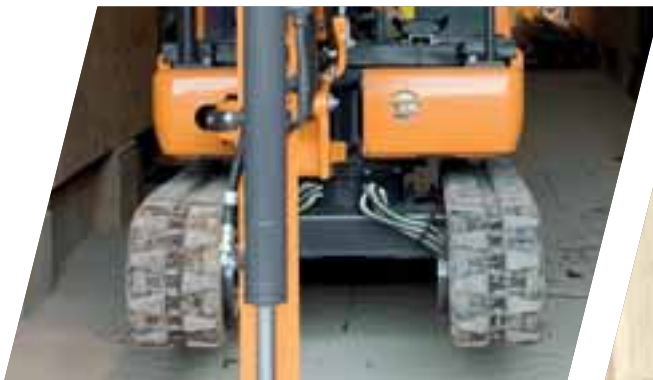
Chaînes rentrées pour accéder aux espaces restreints
