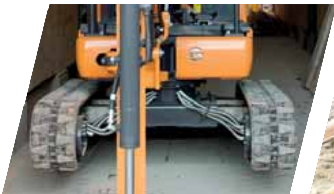
Cingoli estensibili per migliorare la stabilità durante il lavoro
