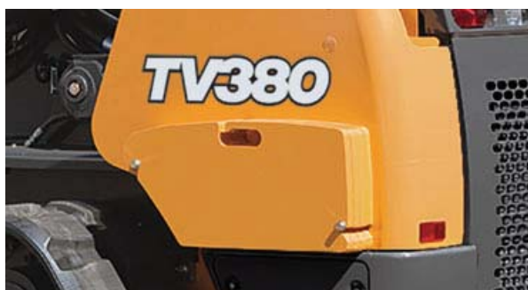
Contrappeso addizionale per incrementare il ROC
