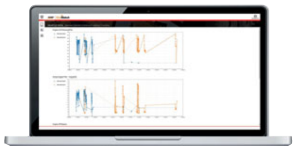
CAN-Bus-Bericht Fahrzeugdaten - Es können 40 Parameter für jede Maschine gewählt und überwacht werden. Sie können entweder als Diagramm zur schnelleren Interpretation oder als exakte Werte für höhere Genauigkeit angezeigt werden.
